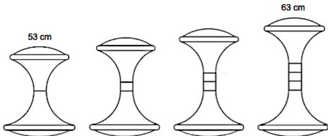
4. Nach dem Aufstecken des Oberteils auf den Führungsstab müssen die nicht benötigte Zwischenringe wieder auf den Stab im Inneren des Oberteils gesteckt und mit Scheibe und Rändelschraube fixiert werden. Die Schraube muss nur leicht von Hand festgedreht werden.
